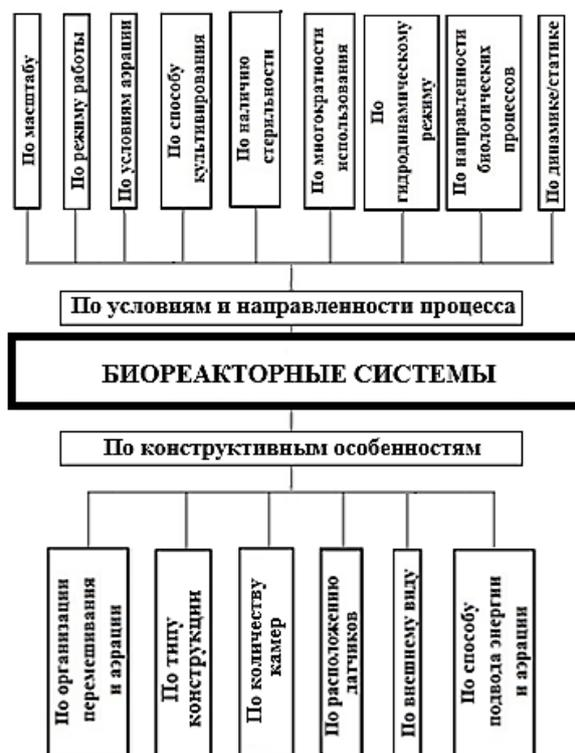
Рисунок 1 – Существующие классификации биореакторных систем / Figure 1 – Existing classifications of bioreactor systems
