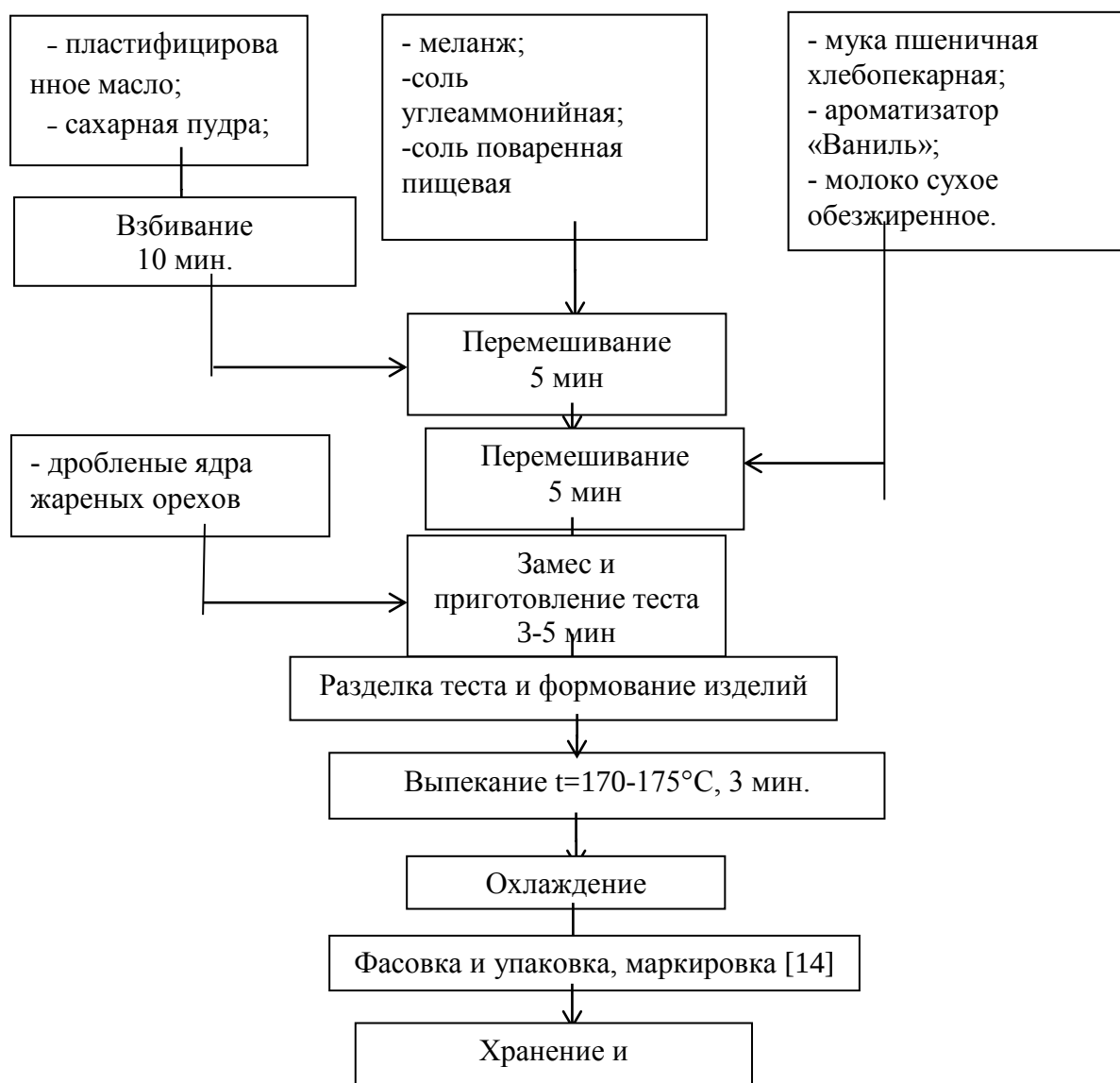
Рисунок 1 – Технологическая схема производства обогащенного печенья Figure 1 – Technological diagram for the production of enriched cookies
