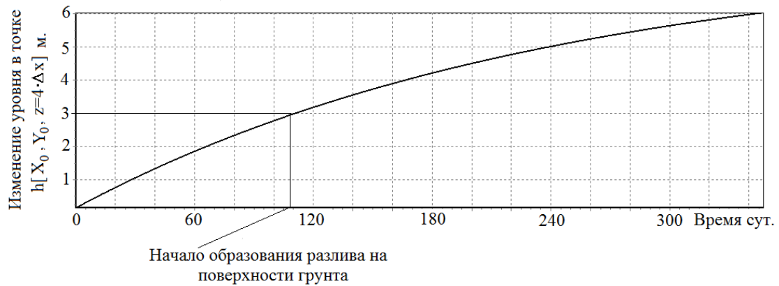
Рисунок 3 – График изменения уровня на поверхности грунта Figure 3 – Graph of the level change on the ground surface
