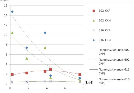
Рис. 1. Значения расчетных и измеренных ко концентраций С / Спдк бензола (602) и ксилола (С616) для расчетной высоты H = 5м (расчетной)
