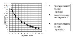
Рис. 1. Кривые сушки вареного риса в кипящем слое при оптимальных режимах сушки
