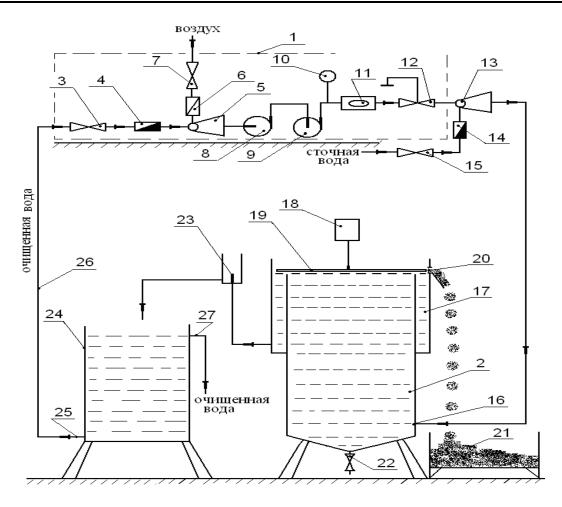
Рис. 1. Устройство для очистки сточных вод напорной флотацией:
