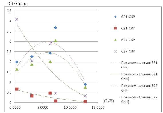
Рис. 4. Значения расчетных и измеренных концентраций С / Спдк толуола (621) и этилбензола (627) для расчетной высоты H=3 м (фактической)
