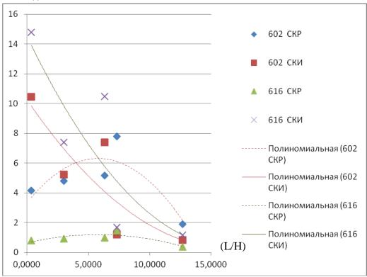
Рис. 3. Значения расчетных и измеренных ко концентраций С / Спдк бензола (602) и ксилола (C616) для расчетной высоты H = 3 м (фактической)
