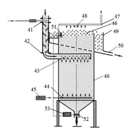
Рис. 3. Устройство для извлечения гидрофобизированных частиц избранных минералов из рудных пульп напорной флотацией:
