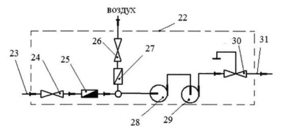
Рис. 2. Известный сатуратор сточной воды:
