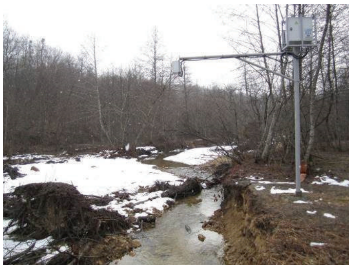
Рис. 5. Общий вид измерительного комплекса «ЭМЕРСИТ» на Г-образной консоли
