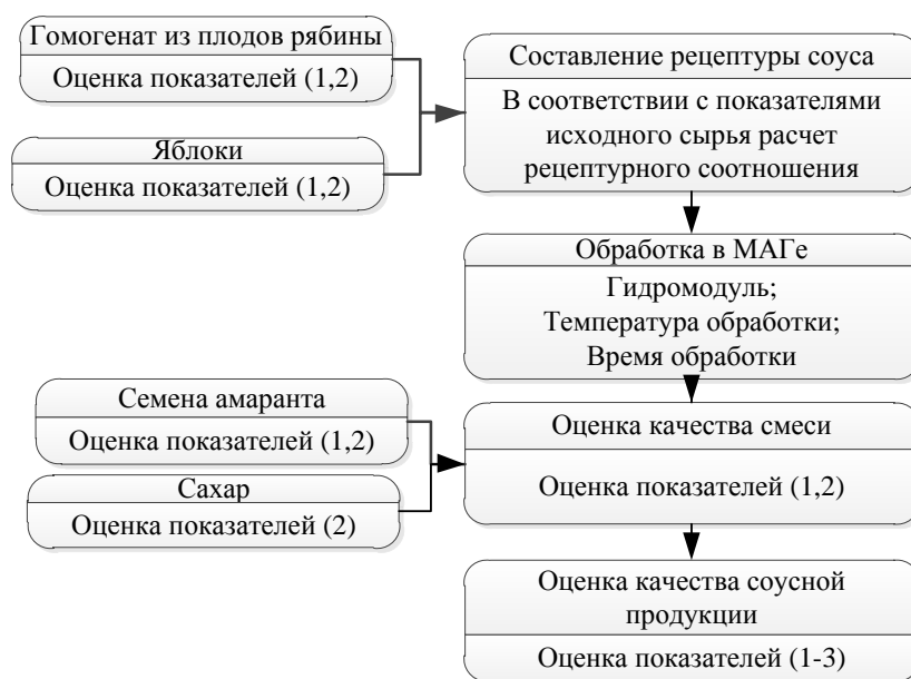
Рис. 1. Технологическая схема получения соусных продуктов (оценка органолептических показателей: 1 – консистенция (текстура); 2 – цвет; 3 – вкус и запах)
