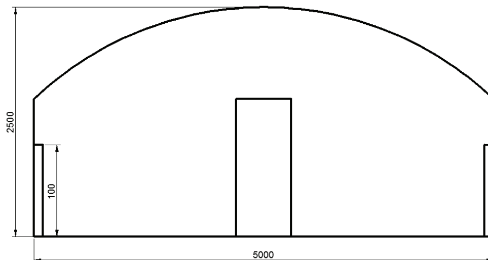
Рис. 1. Помещение теплицы, вид спереди
