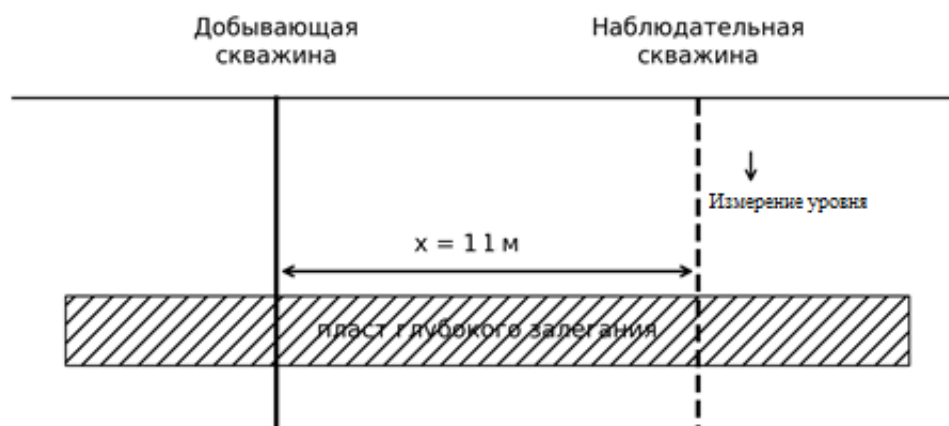
Рисунок 1. Схема использования наблюдательной скважины для фиксации понижения уровня
