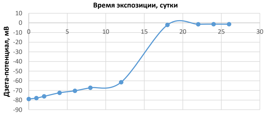
Рисунок 7 – Зависимость дзета-потенциала от времени экспозиции образца № 7 Figure 7 – Dependence of the zeta potential on the exposure time of sample № 7
