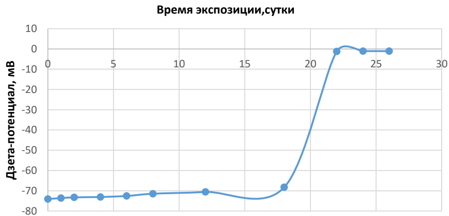
Рисунок 3 – Зависимость дзета-потенциала от времени экспозиции образца № 3 Figure 3 – Dependence of the zeta potential on the exposure time of sample № 3
